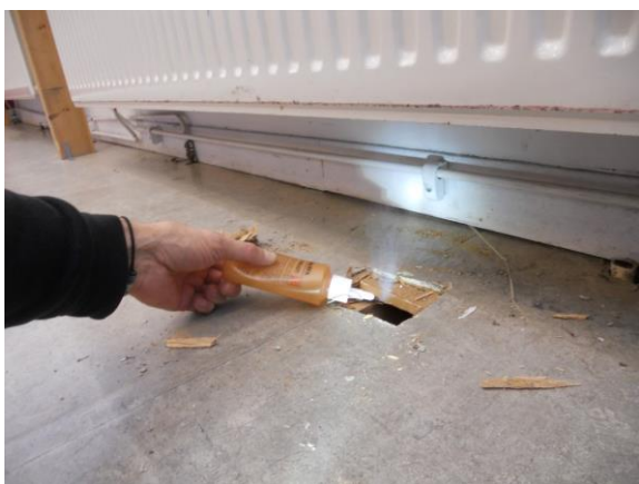
Figur 8. Kall rök visar kraftigt inläckage via golvet
