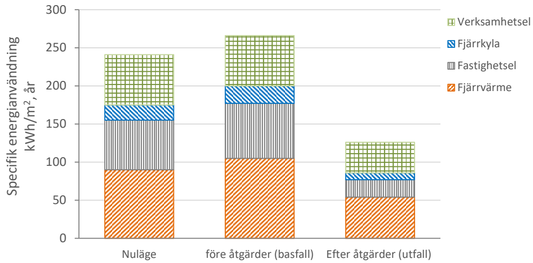
Figur 3.22 Energibehov före- och efter genomfört åtgärds paket och jämfört med nuläge (energistatistik).
