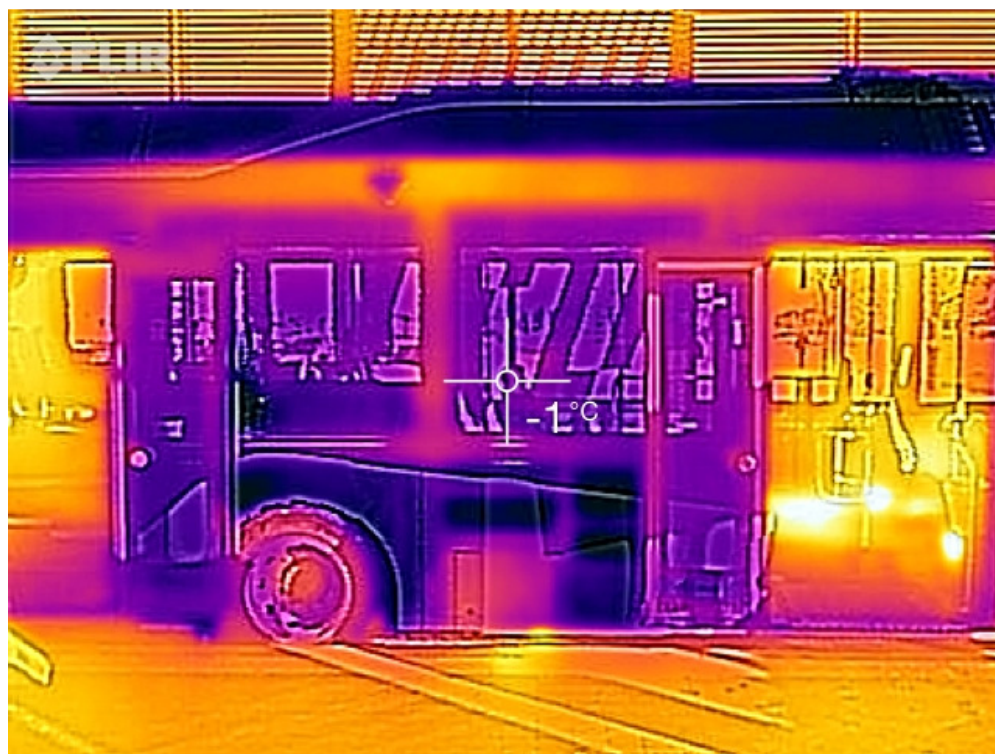
Figur 7.1 Fotografi av buss på hållplatsen, taget med värmekamera. Utetemperatur -10^{\circ}\text{C} . Lufttemperatur 15^{\circ}\text{C} . Genomsnittlig yttemperatur på bussen +7^{\circ}\text{C} (variation från -5^{\circ}\text{C} till +24^{\circ}\text{C} ).
