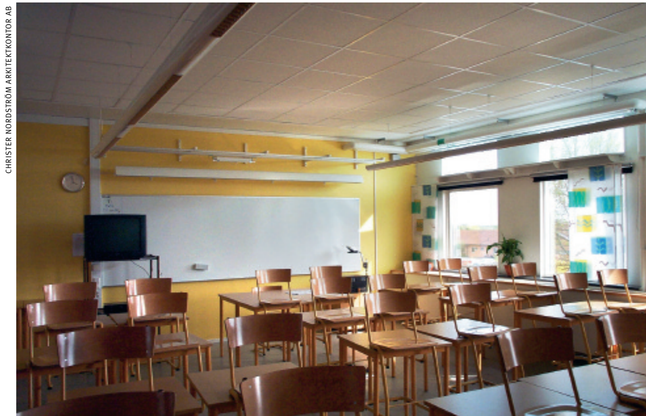
Mellan klassrummens överfönster och huvudfönster finns det reflektorer för dagsljusspridning.
