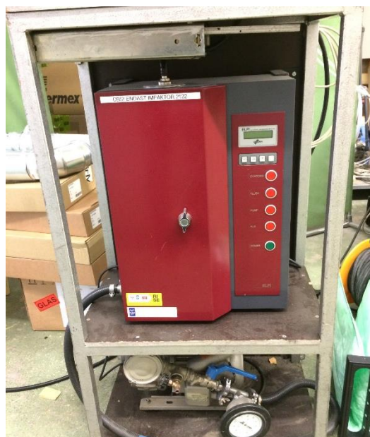
Figur 11 ELPI partikelmätare och exempel på mätning av partikelkoncentration
